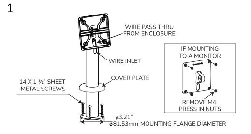
**INSTALL YOUR TABLET ENCLOSURE AS SHOWN USING M4 SCREWS** PROVIDED WITH ENCLOSURE 3
